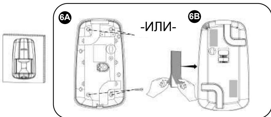
**ПРИМЕЧАНИЕ:** Не следует устанавливать батареи (или удалять с них защитные полоски) или покрытия сразу после монтажа пассивных ИК-датчиков движения.
