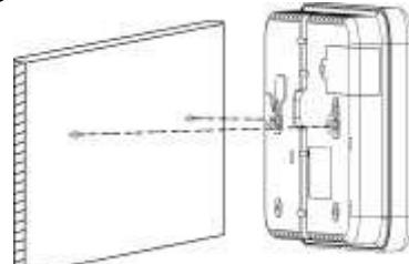
**ВАЖНО:** При монтаже, несмотря на то, что винты входят в крепежные угольники на панели управления в центре, как показано ниже, отверстия под винт / винты должны быть расположены в самой верхней точке крепежных угольников:
