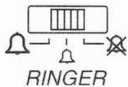
Установите рычажок регулятора уровня громкости звонка RINGER в требуемое положение (ВЫСОКИЙ/НИЗКИЙ/ВЫКЛ.).
