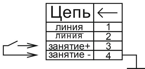
Рис. 1.13 Разводка разъема для подключения к линейному входу ГО
