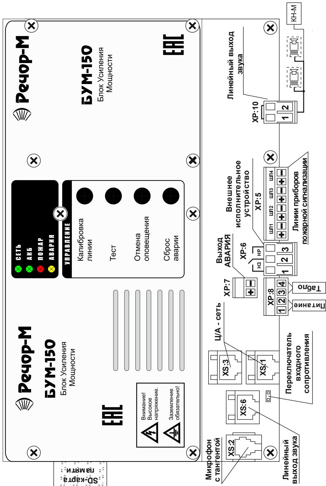
Рис. 1.4 Расположение разъемов для подключения сигнальных цепей
