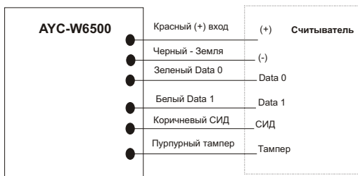
Рисунок 5: Подключение считывателя
