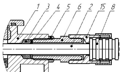
б) монтаж кабелем в металлорукаве
