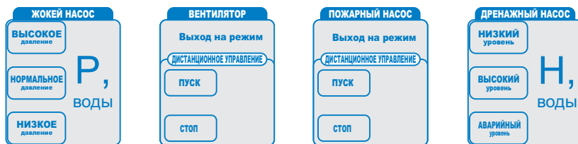
Рисунок 4- Сменная этикетка панели управления ШУ
