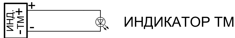
Рисунок 12. Схема включения индикатора считывателя ТМ
