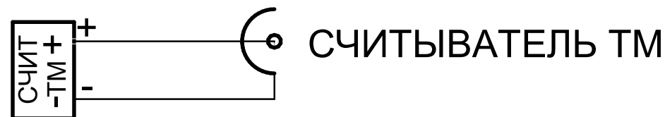
Рисунок 11. Схема включения считывателя для ТМ
