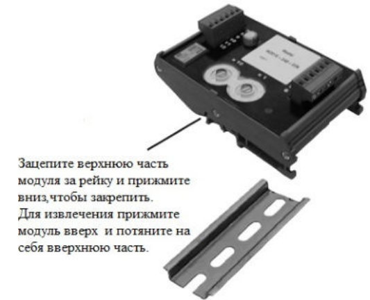
Рис.1б: Модуль управления питанием M201E-240-DIN для монтажа на DIN рейку.
