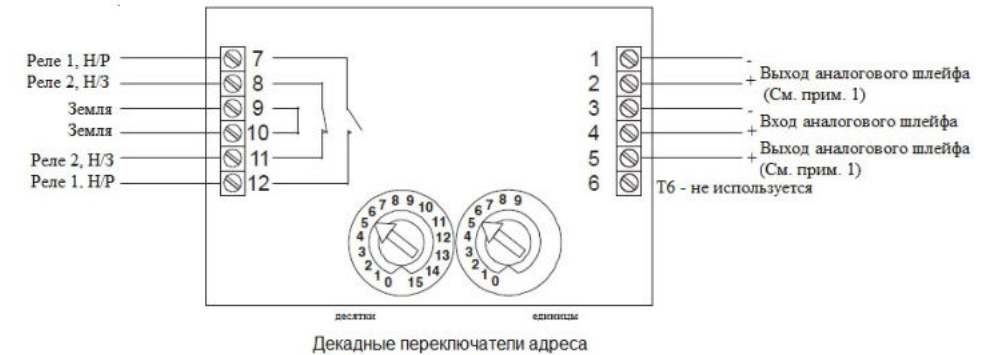
Рисунок 2: Подключение модулей M201E-240 (-KO) и M201E-240-DIN
