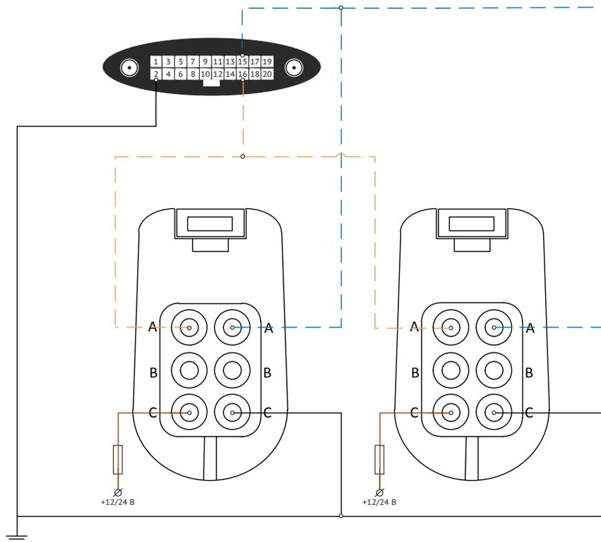
Рисунок 60. Схема подключения двух топливных датчиков Omnicomm LLS-AF20160
