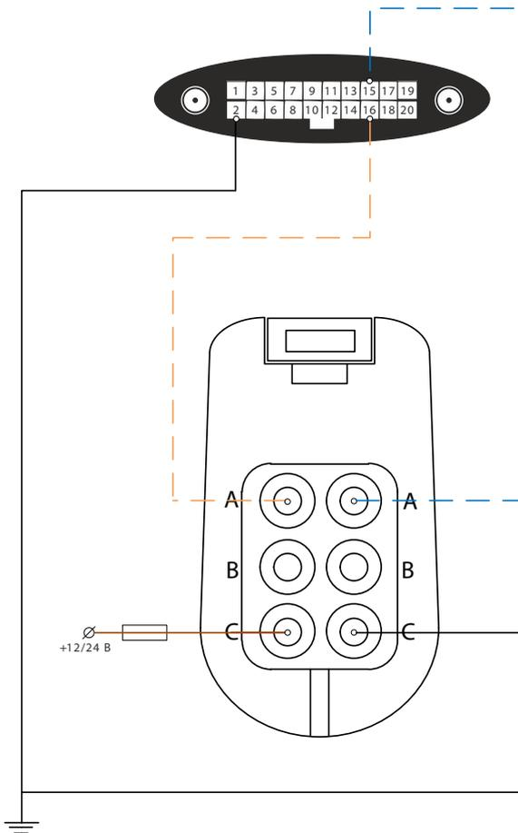
Рисунок 59. Схема подключения топливного датчика Omnicomm LLS-AF20160
