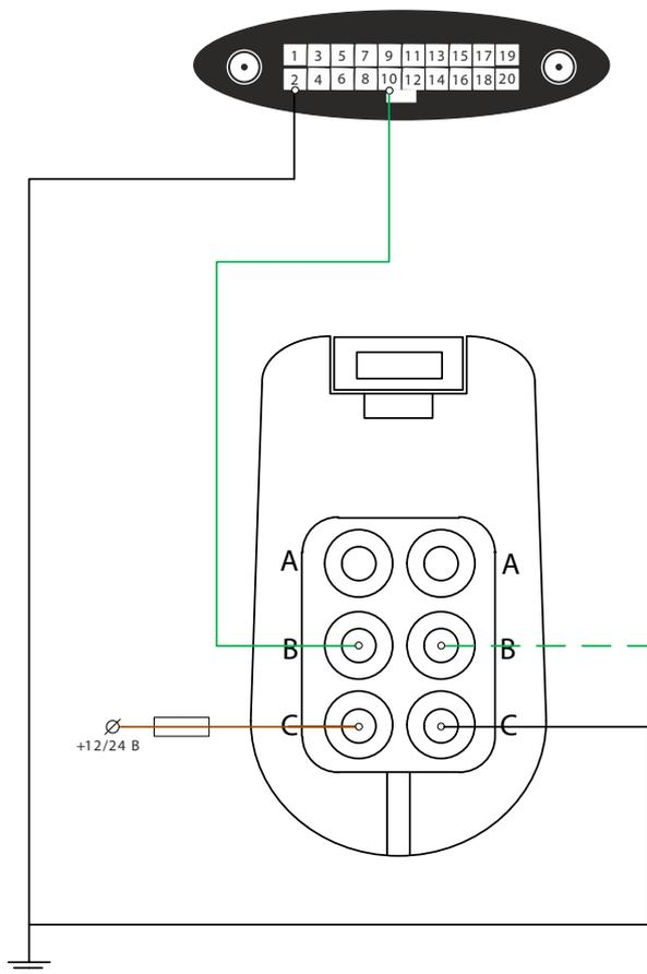
Рисунок 64. Схема подключения частотно-аналогового датчика
