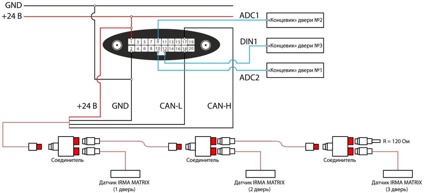
Рисунок 67. Подключение датчиков пассажиропотока IRMA MATRIX
