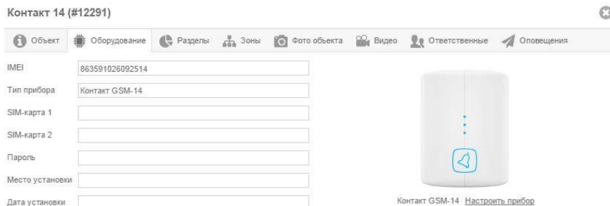
Рисунок 8. Настройка прибора через GEO.RITM
