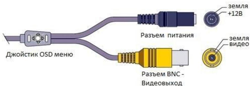
Джойстик OSD меню предназначен для управления переключением режимов работы видеокамеры: АHD/TVI/CVI. А также для более детальной настройки видеокамеры.
