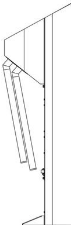
Рисунок 15 – Турникет со сложенными планками (центральная стойка турникета)
