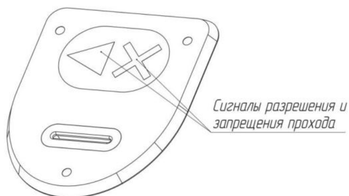
Рис. 2. Внешний вид панели индикации
