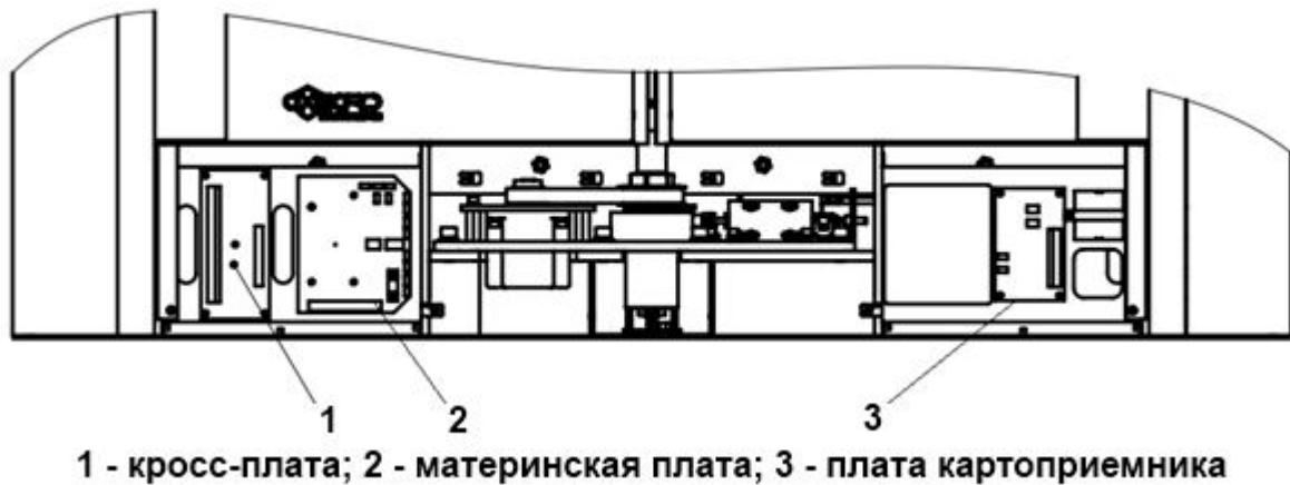
Рисунок 4 – Расположение плат на стойке модуля турникета
