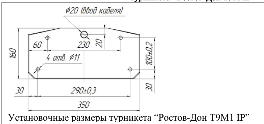
Габаритные размеры турникета "Ростов-Дон Т9М IP"
