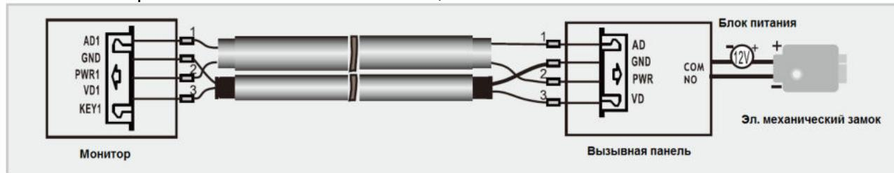
Примечания: если используется экранированный кабель, экран рекомендуется подключить к общему проводу.
