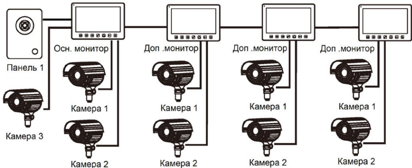
**Примечание:** в качестве дополнительных мониторов могут использоваться мониторы: серии Amelie, серии Lilu, серии Prime, серии Neo, серии Loki, Stark, Tango, Sherlock.
