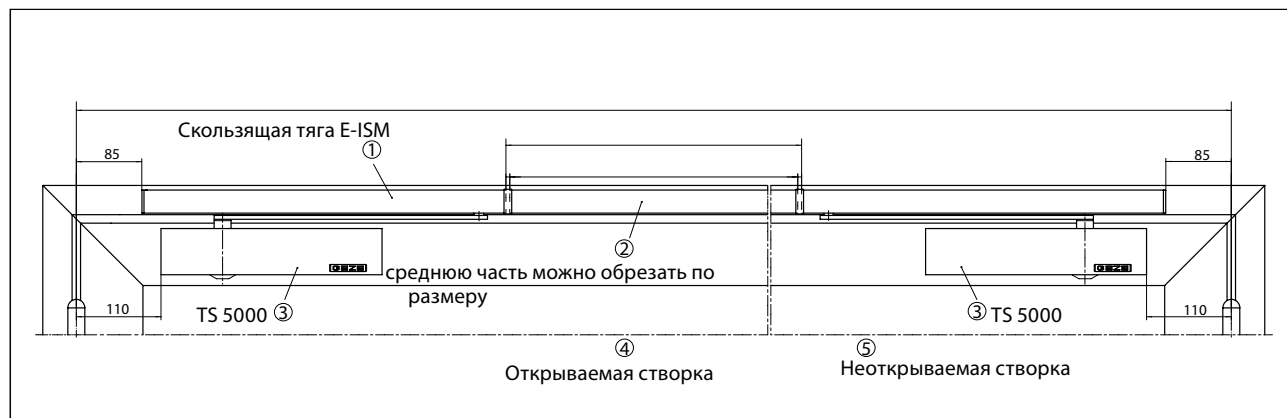
Пример монтажа системы GEZE TS 5000 E-ISM на стальной двери
