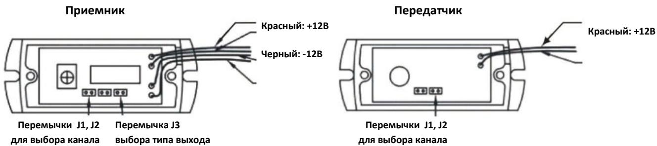
Перемычки J1 и J2 используются для установки одного из 4-х каналов, данные перемычки должны быть установлены одинаково для приемника и передатчика. Перемычка J3 используется для установки типа выхода. Установите данную перемычку, если требуется НЗ выход, а если требуется НР, уберите перемычку.
