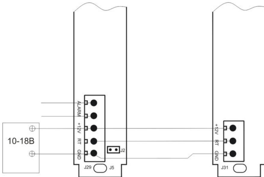
**Подключение без линии синхронизации.** Если защищается только один участок, то возможно использование барьера без линии синхронизации. В этом случае перемычку J2 приемника необходимо установить.
