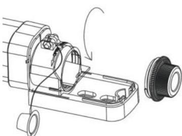
5. Потяните плату за отверстие в указанном направлении для получения доступа к разъемам.
