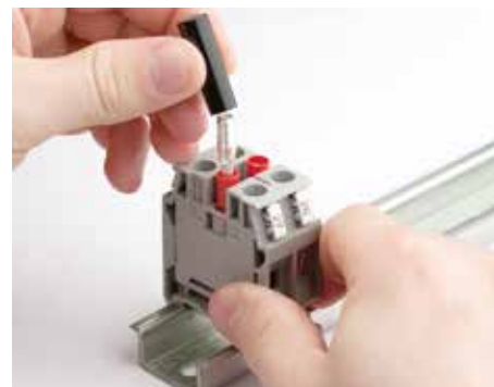
3. Закрепите прижимным винтом проводник в щупе
