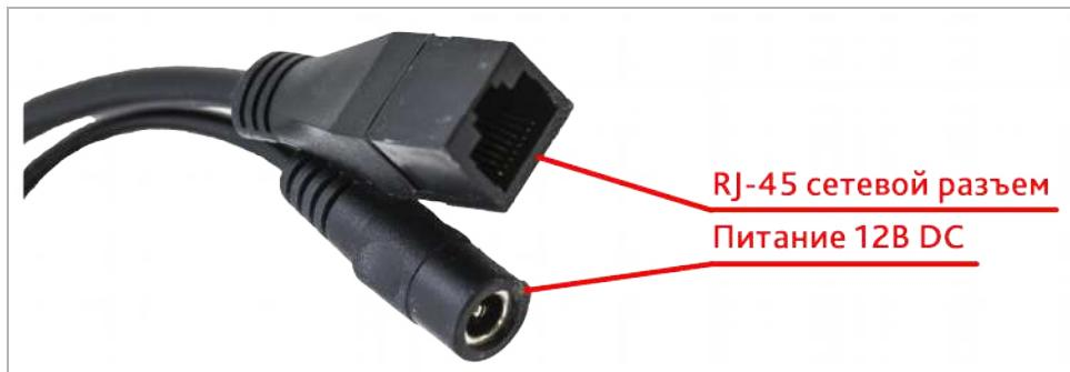
Внешние разъемы IP-камер AC-D2111IR3:
