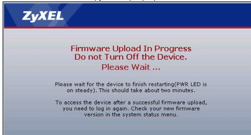
По окончании загрузки микропрограммы P-791R v2 автоматически перезапускается, что приводит к временному отключению от сети. В некоторых операционных системах на рабочем столе может находиться следующий значок.
