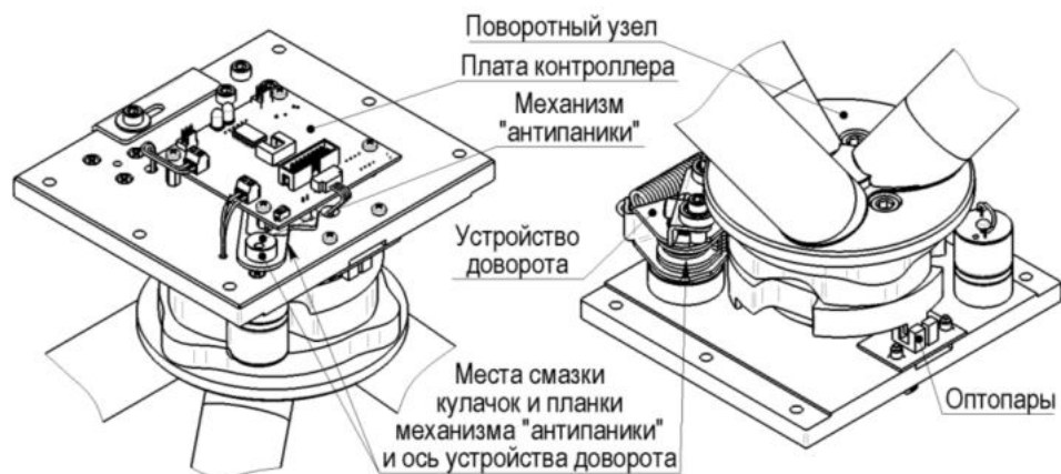
Рис.8 Расположение узлов и деталей трения. Места смазки
