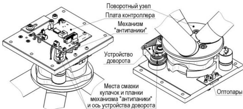
Рис.8 Расположение узлов и деталей трения. Места смазки
