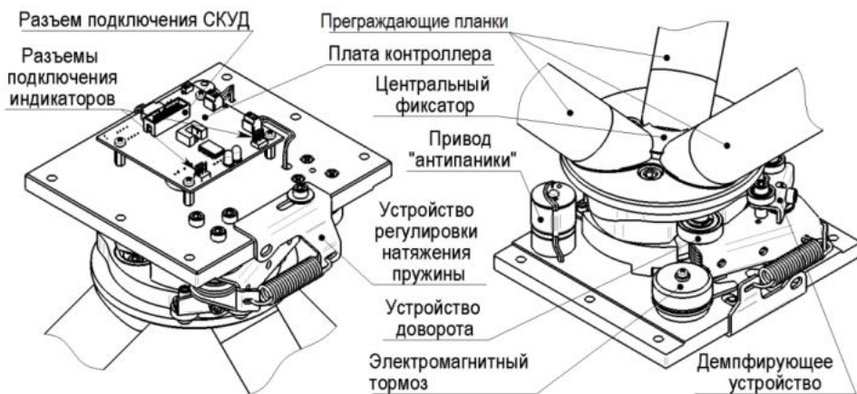
Рис.4 Механизм турникета (вид верхней и нижней части).
