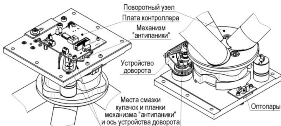
Рис.7 Расположение узлов и деталей трения. Места смазки
