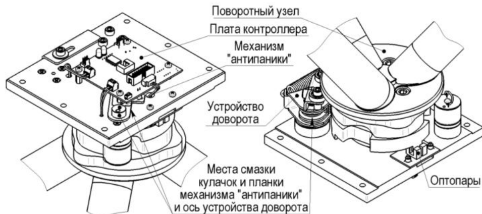
Рис.7 Расположение узлов и деталей трения. Места смазки
