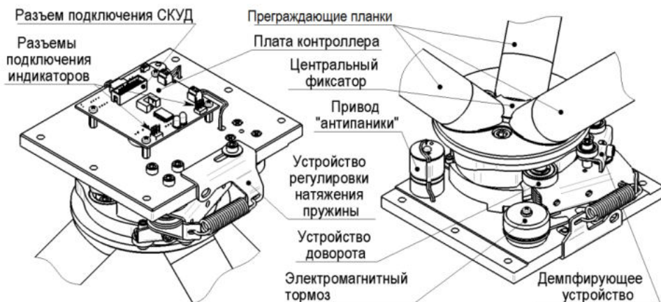
Рис.4 Механизм турникета (вид верхней и нижней части).
