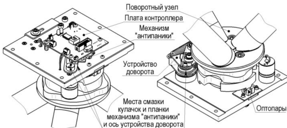
Рис.7 Расположение узлов и деталей трения. Места смазки
