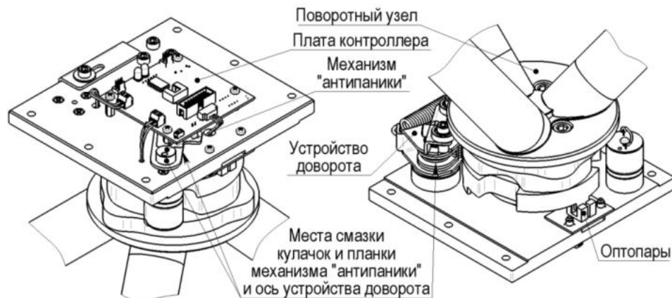
Рис.7 Расположение узлов и деталей трения. Места смазки
