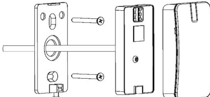
Для подключения рекомендуется кабель UTP с сечением каждого провода не менее 0,22 мм<sup>2</sup>. Сигналы DATA 0 и DATA 1 рекомендуется передавать в отдельных повитых парах с замыканием второго повивающего проводника на GND контроллера СКУД.
