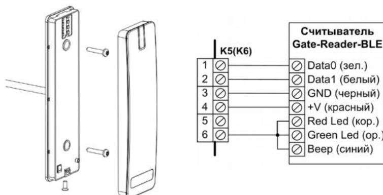
Для подключения рекомендуется кабель UTP с сечением каждого провода не менее 0,22 мм<sup>2</sup>. Сигналы DATA 0 и DATA 1 рекомендуется передавать в отдельных повитых парах с замыканием второго повивающего проводника на GND контроллера СКУД.
