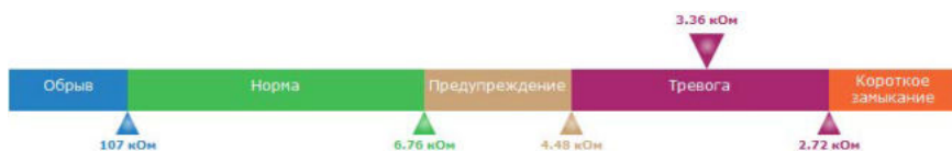
Рисунок 21. Шкала порогов пожарного шлейфа
