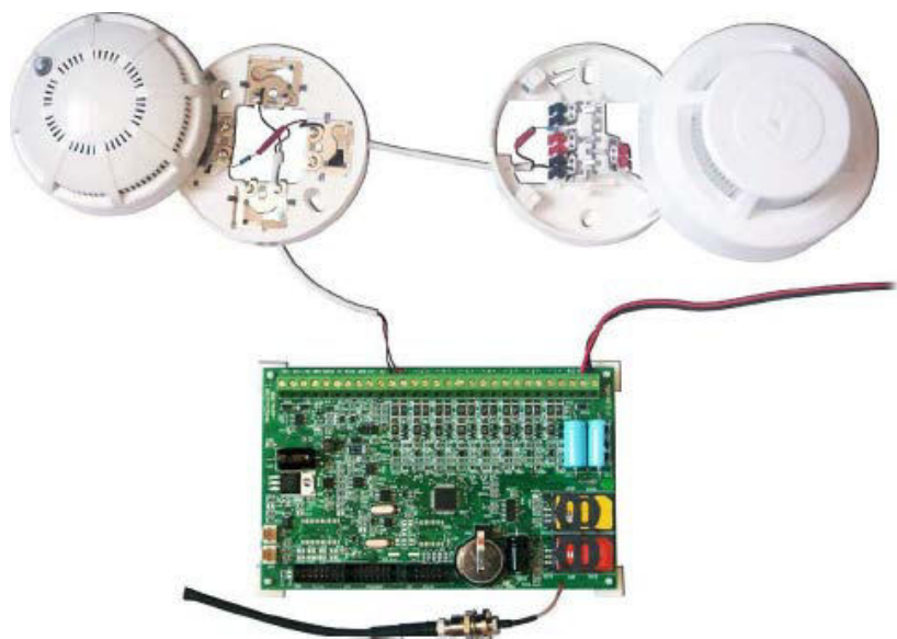
Рисунок 49. Фотография подключения двух пожарных датчиков
