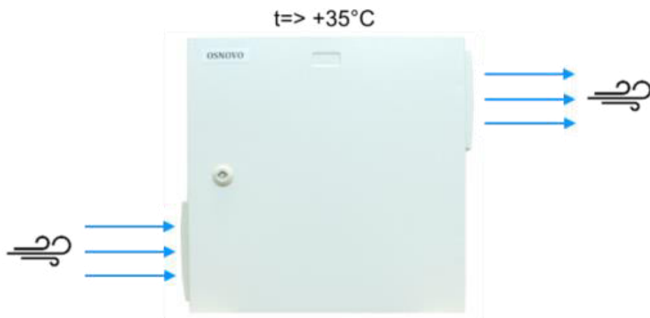
Рис. 4 Принцип работы системы проточной вентиляции
