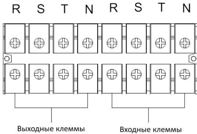
Рис. 2-3-1 Блок клемм ИБП ХЕ 30(WB) / 40(WB)
