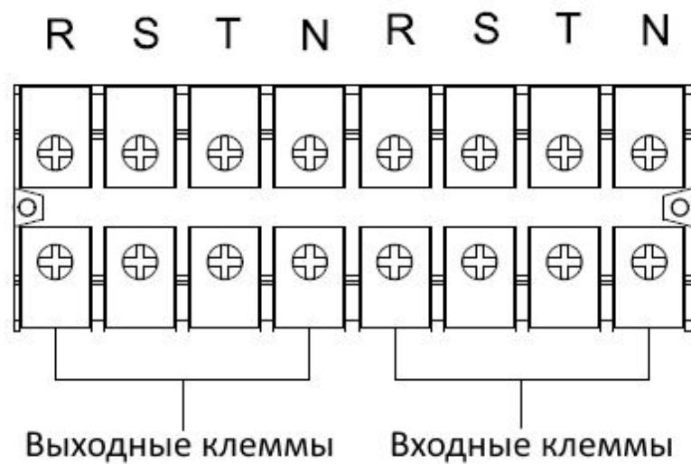
Рис.2-3-2 Блок клемм ИБП ХЕ 60 / 80
