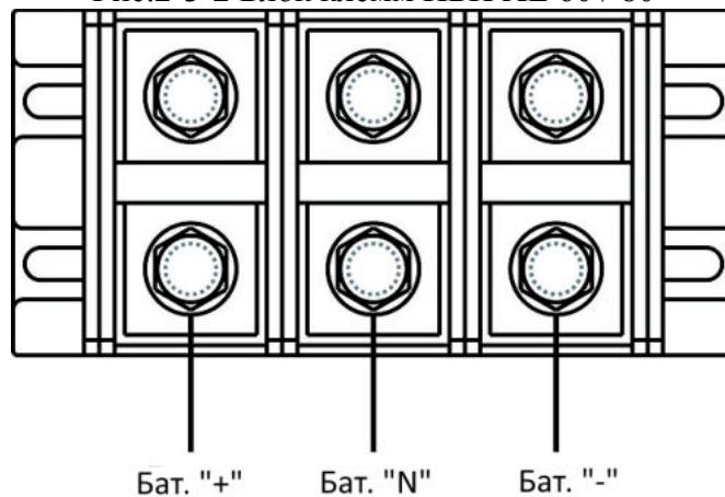
Рис.2-3-3 Блок клемм ИБП ХЕ 60 / 80 для подключения аккумуляторных батарей
