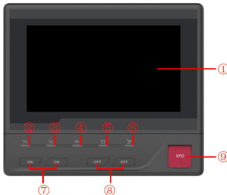
Рис. 6.2 Лицевая панель ИБП Monolith XL40-160
