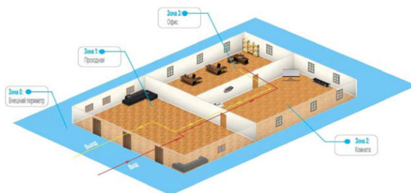
Рис 6. Распределение зон доступа
