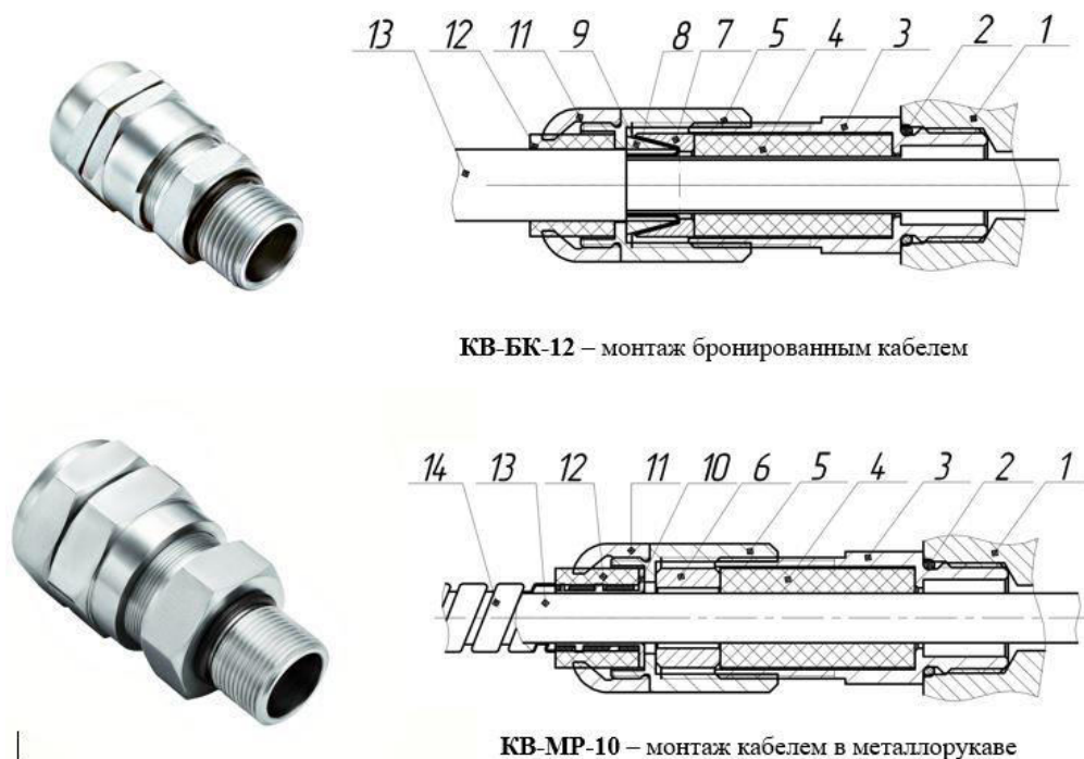
Рисунок 13 – Вводные устройства с двойным уплотнением
