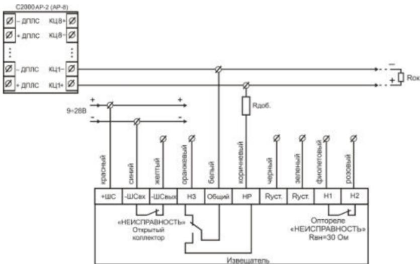
Рисунок 10 – 4-х проводная схема подключения к С2000-АР2 (АР-8)
