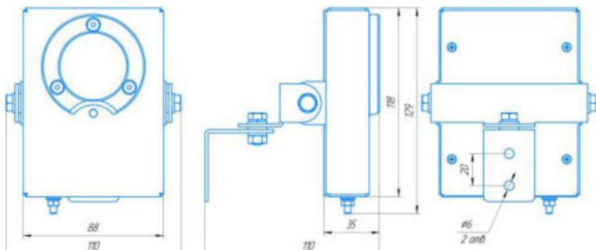
Рис. 4. Спектрон-601-Exi-C-M, -601-Exi-C-H, -601-Exm-C-M, -601-Exm-C-H.
