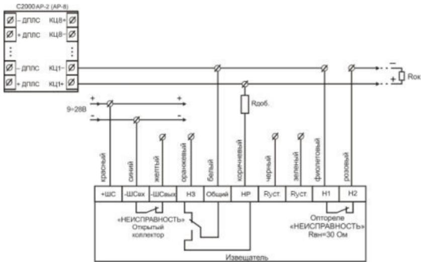
Рисунок 11 – 4-х проводная схема подключения к C2000-AP2 (AP-8) с использованием режима «НЕИСПРАВНОСТЬ»
