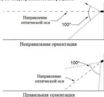
Рисунок 5 – Установка извещателя по отношению к горизонту
