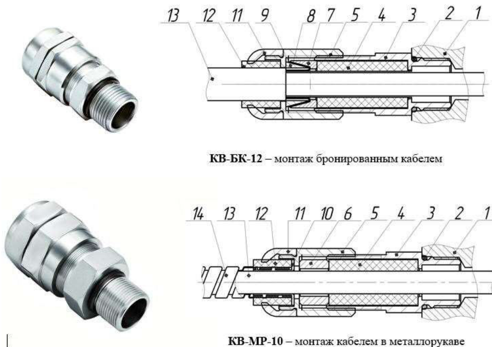
Рисунок 12 – Вводные устройства с двойным уплотнением
