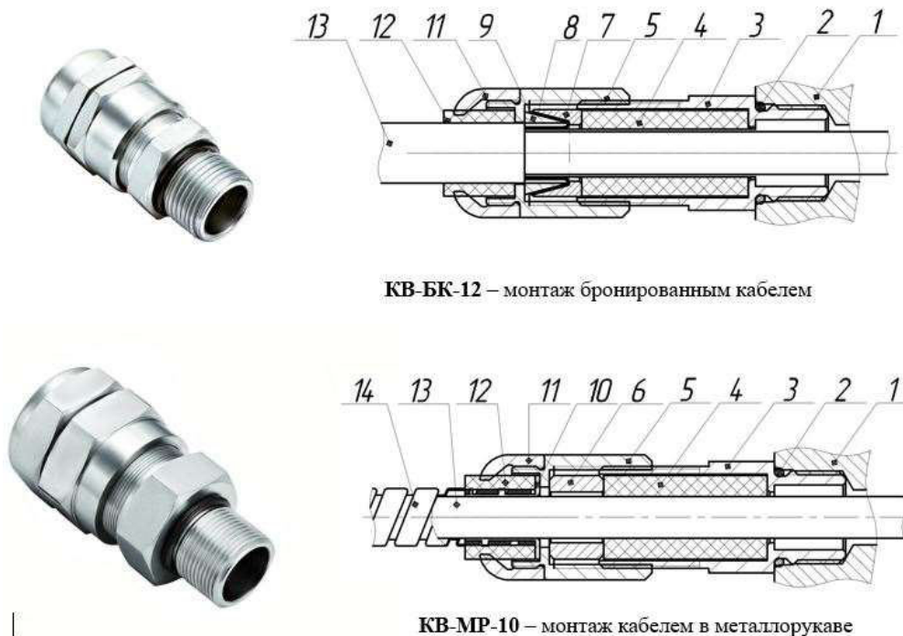
Рисунок 12 – Вводные устройства с двойным уплотнением
