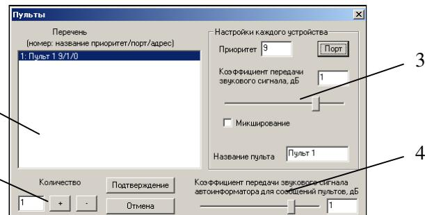
Рисунок 7.10. Диалоговое окно конфигурирования пультов. 1 – перечень пультов, 2 – элементы управления количеством пультов, 3 – настройки каждого пульта, 4 – общие параметры пультов.
