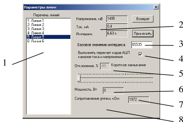
Рисунок 7.54. Диалоговое окно измерения параметров линий. 1 – перечень линий оповещения, 2 – измеренные значения (напряжение, ток, импеданс), 3 – эталонное значение импеданса, 4 – переключатель пересчета кодов АЦП, 5 – результаты сравнения, 6 – примерная мощность линии, 7 – измеренное значение утечки, 8 – информационная строка.
