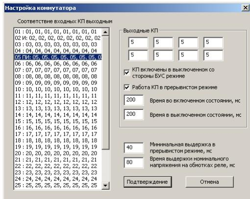
Рисунок 7.43. Окно редактора конфигурации коммутатора.
