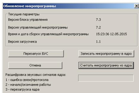
Рисунок 7.53. Диалоговое окно обновления микропрограммы главного микроконтроллера станции.
