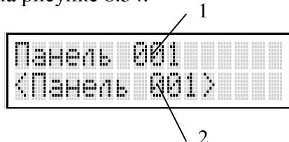
Рисунок 8.34. Экран в режиме выбора вызывной панели. 1 – номер вызывной панели, 2 – название выбранной панели.
