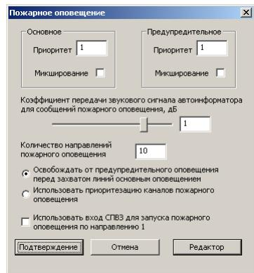
Рисунок 7.20. Диалоговое окно конфигурирования пожарного оповещения.
