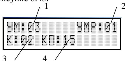
Рисунок 8.43. Экран в режиме задания параметров резервирования усилителей. 1 – Номер резервируемого усилителя, 2 – номер резервирующего усилитель, 3 – номер коммутатора переключающего, 4 – номер контактной пары коммутатора переключающего.
