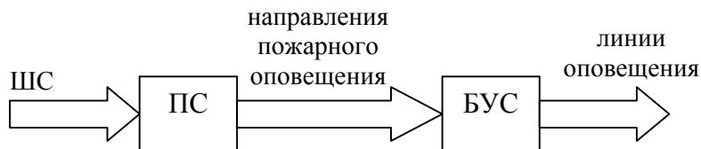
Рисунок 6.6. Сущности пожарного оповещения.
