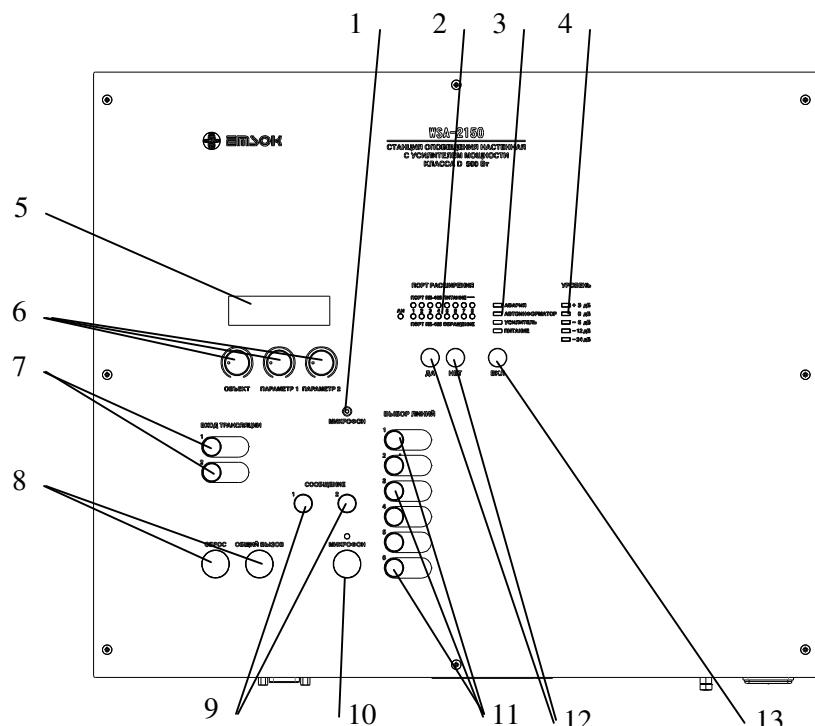
Рисунок 6.1. Передняя панель станции. 1 – Микрофон, 2 – индикаторы состояния портов, 3 – индикаторы режимов работы станции, 4 – индикатор уровня сигнала усилителя, 5 – ЖКД, 6 – поворотные переключатели, 7 – кнопки включения режима управления МВ, 8, 11 – кнопки выбора линий, 9 – кнопки управления сообщениями, 10 – кнопка управления микрофоном, 12 – кнопки управления «Да» и «Нет», 13 – кнопка управления режимом питания «Вкл».
