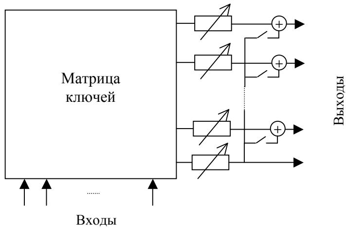
Рисунок 6.5. Схема прохождения сигнала через аналоговую матрицу.
