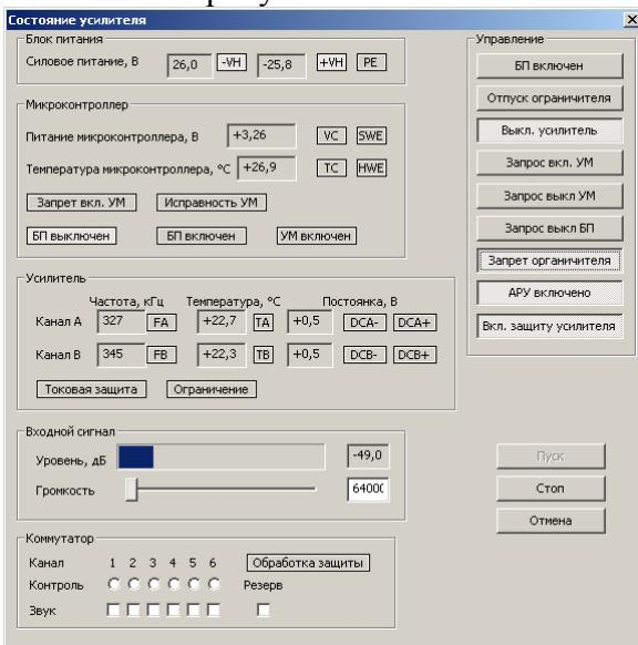
Рисунок 7.48. Окно просмотра состояния и управления усилителем.
