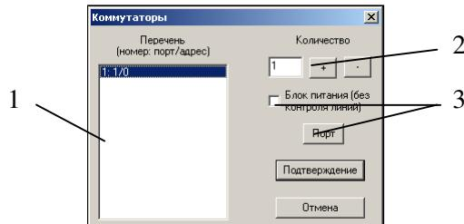
Рисунок 7.12. Диалоговое окно конфигурирования коммутаторов. 1 – перечень коммутаторов, 2 – элементы управления количеством коммутаторов, 3 – настройки каждого коммутатора.
