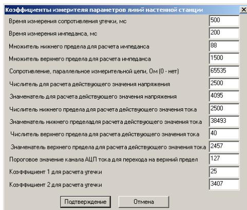
Рисунок 7.7. Диалоговое окно настройки коэффициентов измерителя параметров линий.
